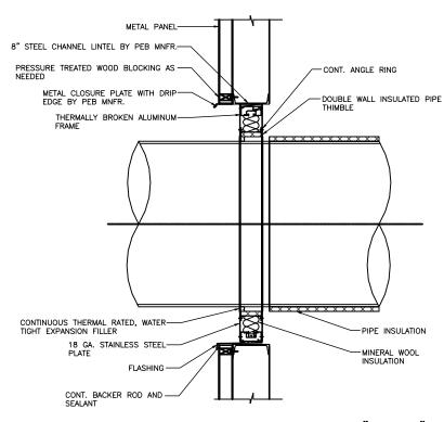
TYPICAL WALL PENETRATION DETAIL 14" TO 30"
